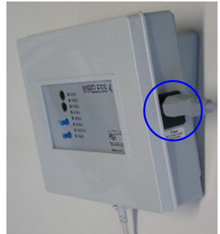
Position der Netzbuchse an der Mainstation W4.2
